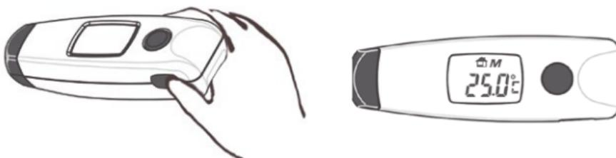
Расположите инфракрасный датчик напротив предмета на расстоянии 2 см. Нажмите кнопку измерения температуры предметов и удерживайте в течение 2 секунд. При окончании измерения Вы услышите звуковой сигнал из динамика, на экране появится значение измеренной температуры. Для измерения температуры воздуха (например, в комнате) просто направьте датчик «в воздух».
